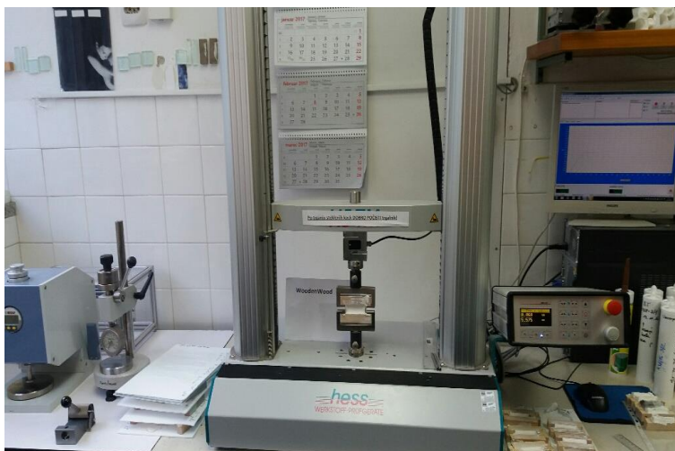
Фото 2: Устройство для определения свойств растяжения (H5 TM Hess)
