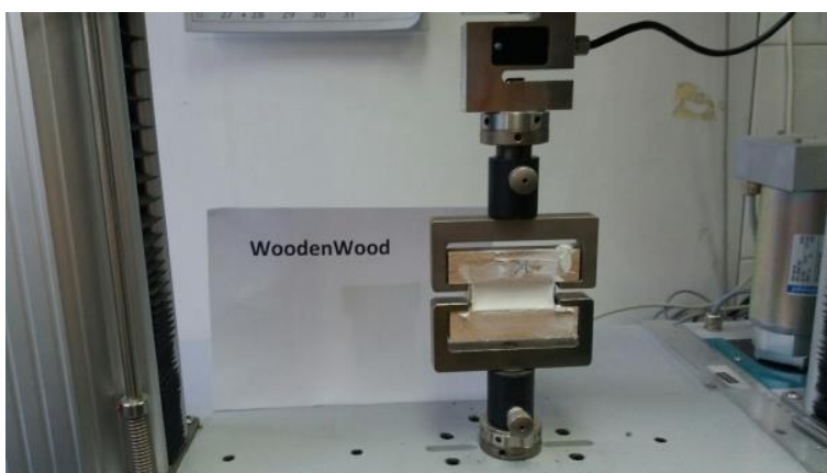
Фото 3: Определение свойств при растяжении
